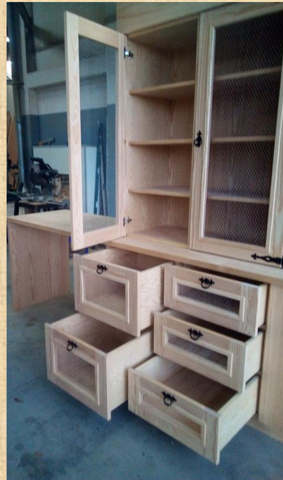
Armário rústico com frentes decoradas com rede, em pinho e com acabamento a maçarico (fotos antes e depois do acabamento)
